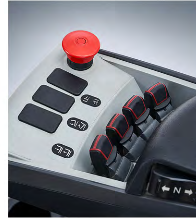
Minipalancas: Minipalancas hidráulicas montadas en el reposabrazos del asiento.
