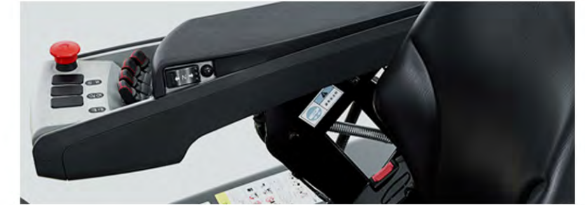
Minipalancas: Minipalancas hidráulicas montadas en el reposabrazos del asiento.
