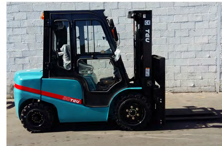
Cabinas a medida: Cabinas confortables con calefacción y aire acondicionado. Robusto diseño de acero, totalmente acristalada, con luna trasera abatible y ventanas laterales.
